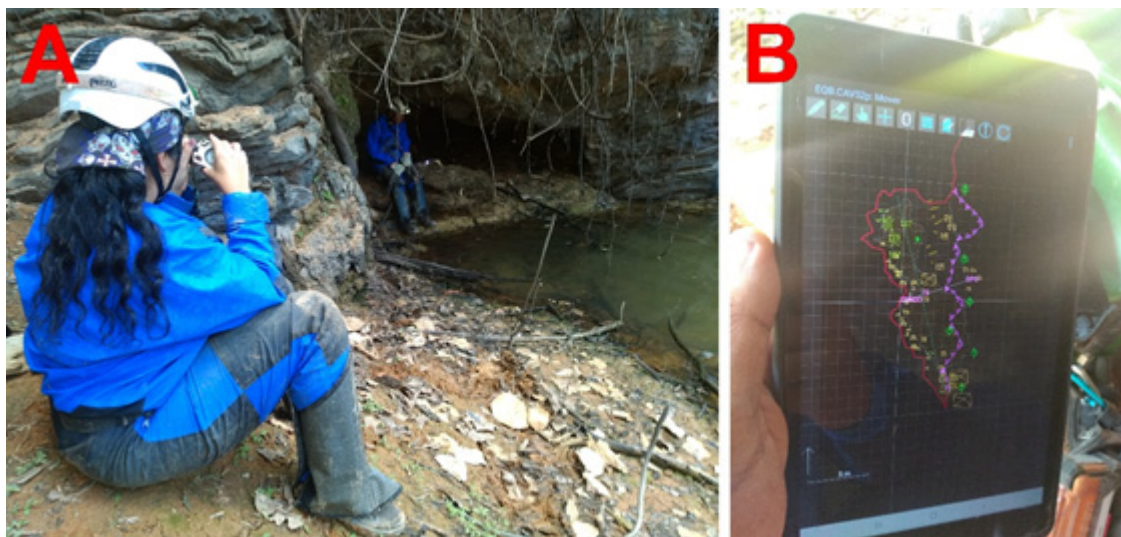
Figura 9 - (A) Equipe de Espeleotopografia realizando as medidas do mapeamento. (B) Utilização do tablet com o Topodroid para auxiliar na representação cartográfica da cavidade natural subterrânea.
