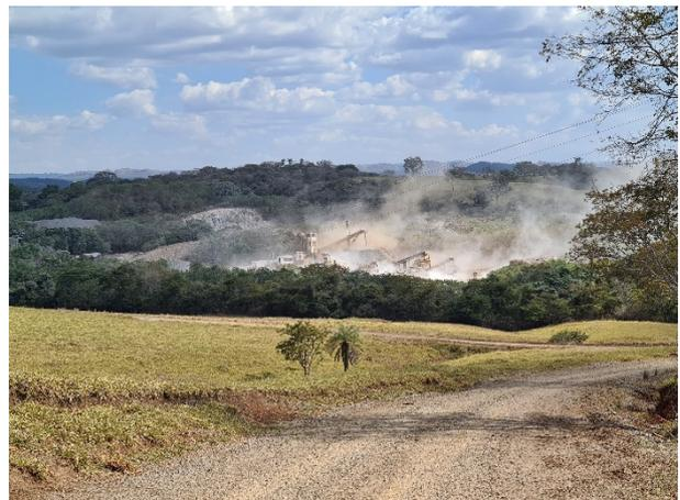
**Figura 96. Material particulado em suspensão na pedreira Contagem, vista a partir de propriedade rural lindeira.**
