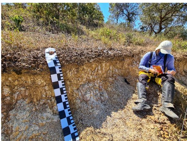
**Figura 29. Crosta laterítica contínua com espessura da ordem de 10 cm.**
