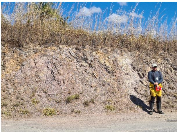
**Figura 17. Afloramento de filito deformado exibindo pastilhamento, próximo à DF-205.**
