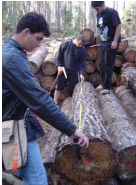
Figura 11. Medição do comprimento da tora ou torete com fita métrica.
