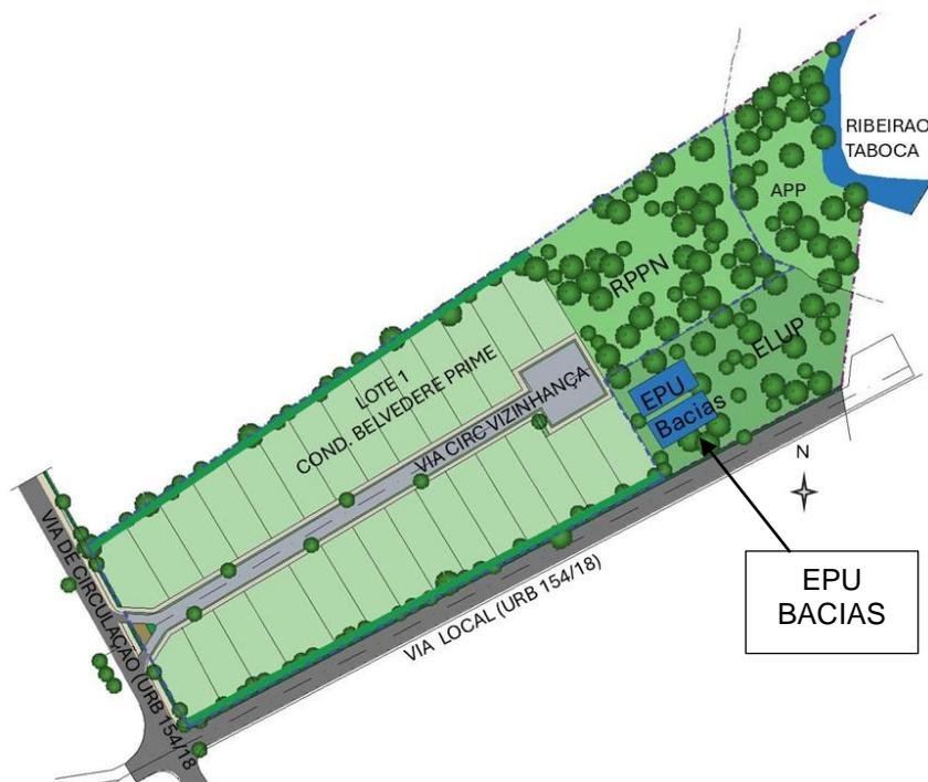
Figura 4: Croqui do sistema de amortecimento.
