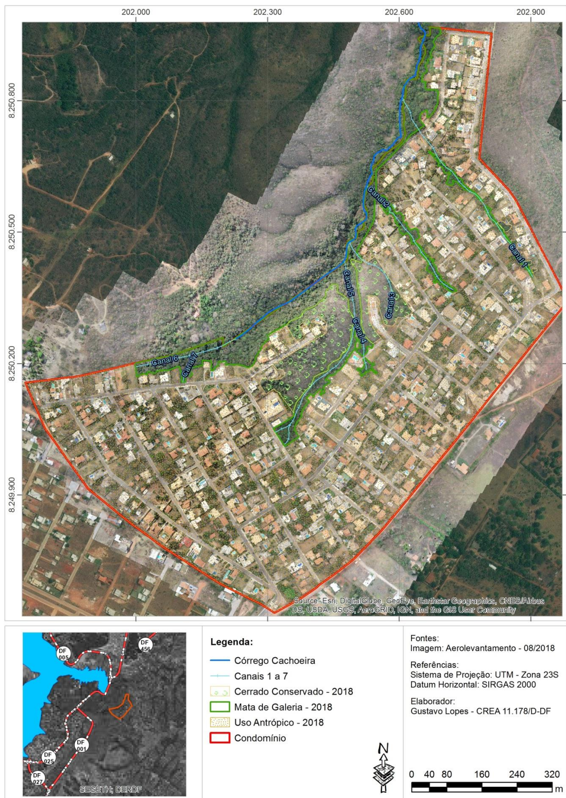
Figura 18. Mapa de uso e cobertura do solo atual do Condomínio Privê Morada Sul - Etapa A com base na imagem aérea de 2018.
