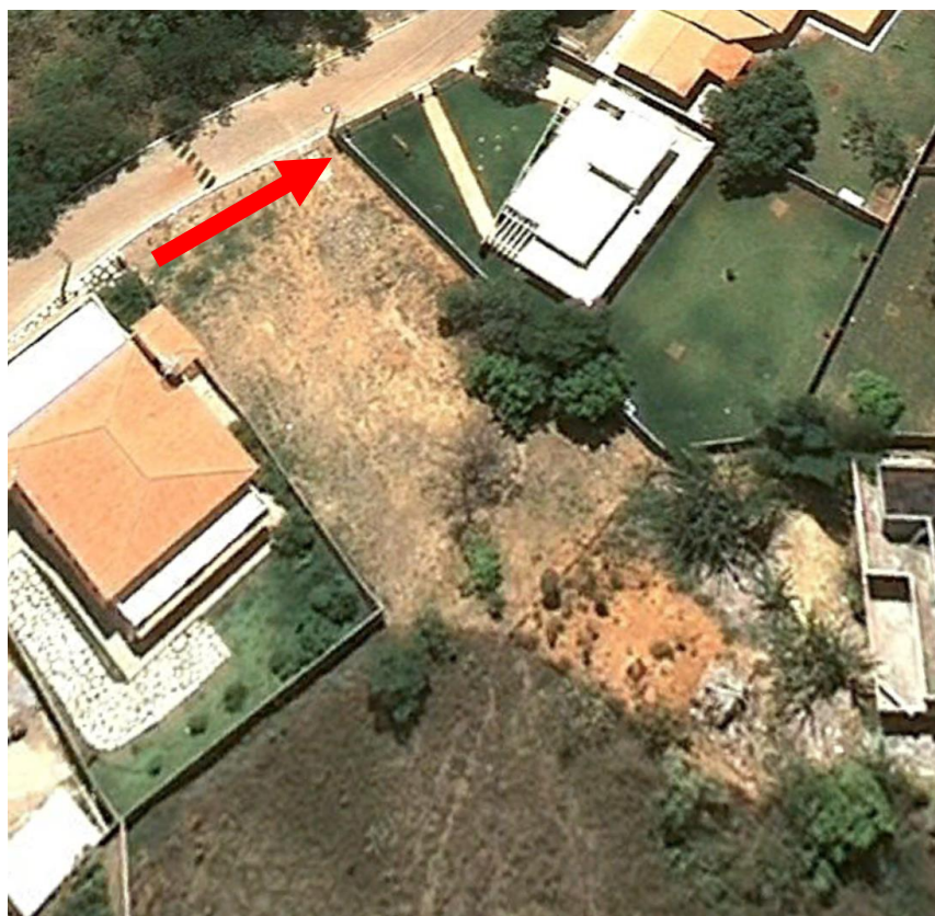
Figura 3 - Imagem Google Earth de 2008 ampliada de forma a mostrar a existência de bueiro que escoar a água do canal natural e do próprio lote 26 para jusante
