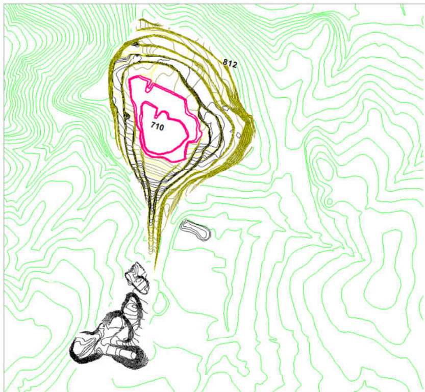
Figura 206 Figura ilustrativa das cotas mínimas e máxima da cava existente alvo de recuperação ambiental.
