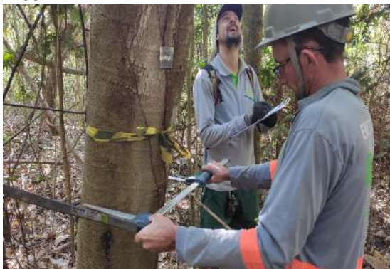
Figura 8 – Medição de DAP (Diâmetro Altura do Peito) em espécie de mata de galeria na parcela MG82.
