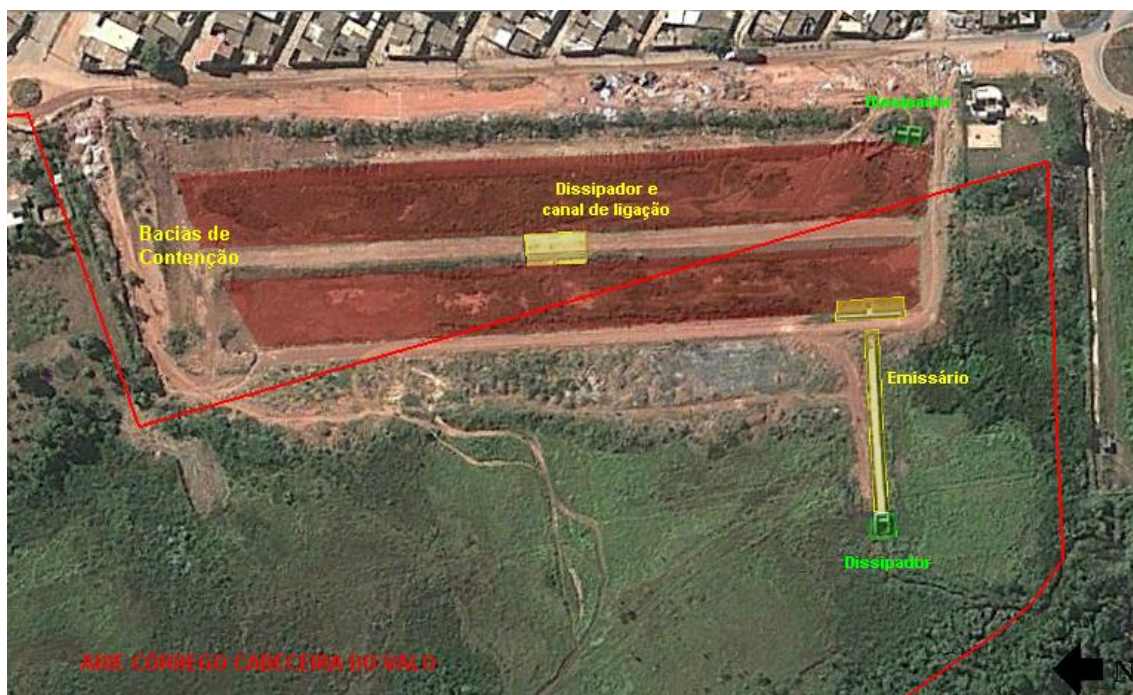
Figura 198- Imagem de satélite ilustrando o sistema de drenagem pluvial incidindo na porção sul da ARIE Córrego Cabeceira do Valo.
