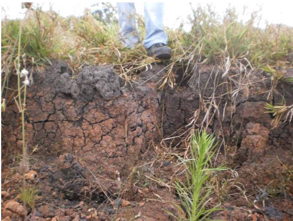
Figura 25 – Detalhe do perfil de gleissolo. Notar a presença do horizonte A escuro (coordenada UTM 178199;8252685).
