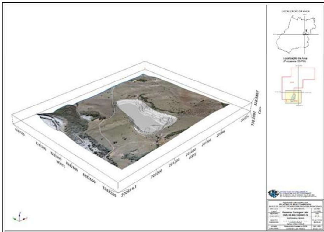
Figura 163: Bloco 3D da imagem com a projeção pit final da área da etapa 1 de exploração mineral (vista 45Az e inclinação 30°) que deverá ser alvo de recuperação imediatamente ao fim da lavra pretendida.
