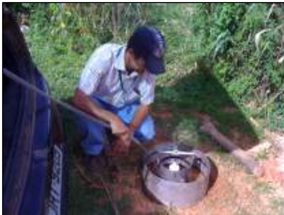
Figura 33: Procedimento de execução do ensaio de infiltração pelo método de anéis concêntricos Fonte: Topocart, 2010.
