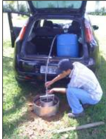
Figura 33: Procedimento de execução do ensaio de infiltração pelo método de anéis concêntricos Fonte: Topocart, 2010.
