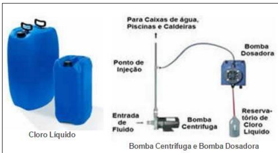
Figura 2.39:Estrutura de Bomba Dosadora.
