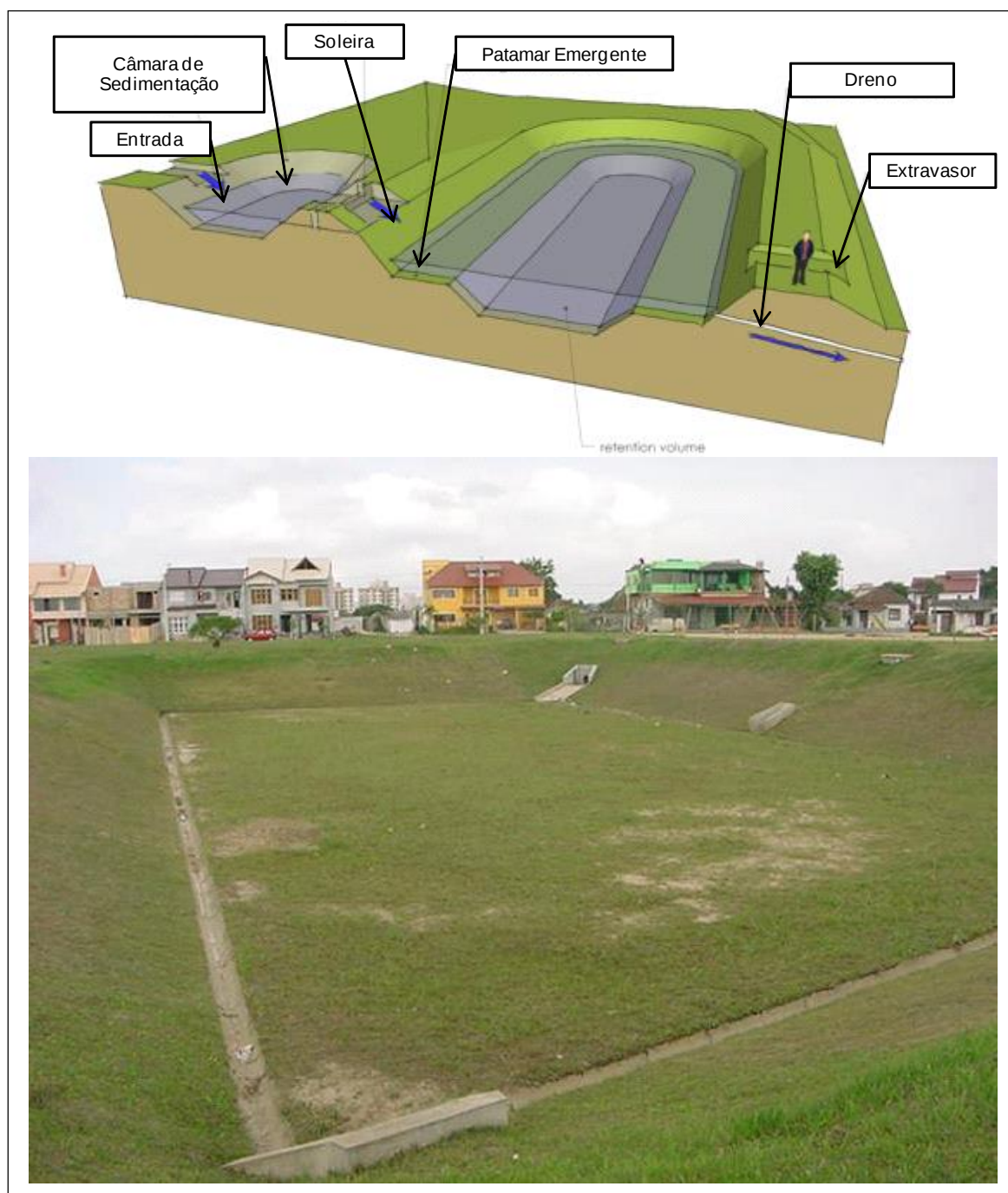
Figura 2.6: Esquema e exemplo de bacia de retenção.
