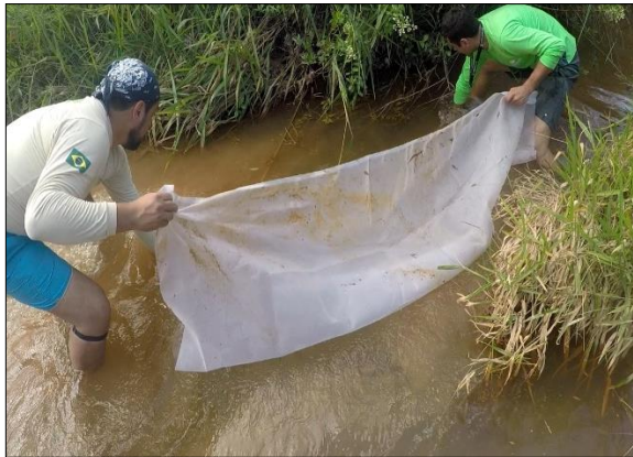
Foto 4.24: Rede de arrasto (2 x 1,5 m e malha de 2 mm).
