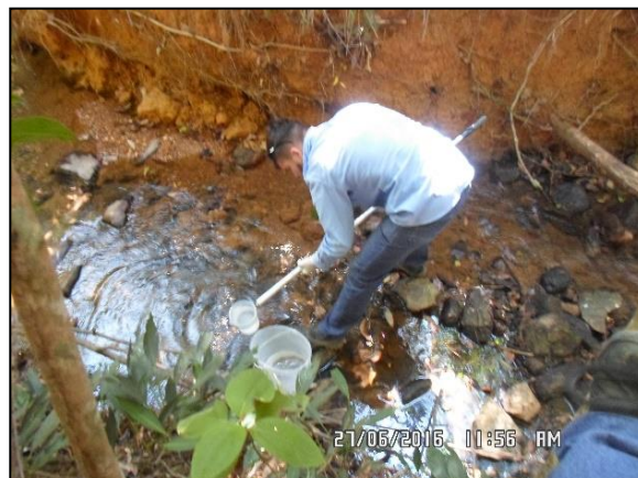
Foto 1.32: Caracterização do ponto de coleta e procedimento de coleta de água do ponto amostral QA-3.
