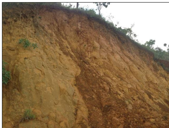
Foto 1.25: Material rochoso apresentando bastante alterado originado do saprólito de filito do Grupo Canastra - MPc.
