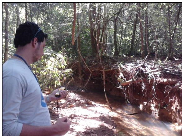
Foto 1.43: Procedimento de georreferenciamento dos pontos amostrais de qualidade de água.
