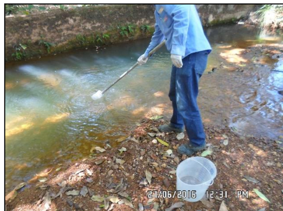
Foto 1.30: Procedimento de coleta de água do ponto amostral QA-2.
