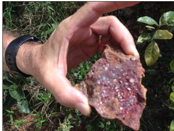
Foto 1.8: Detalhe do aspecto da concreção lateríticas que sustenta as bordas de chapada.
