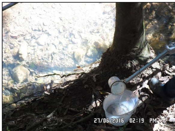
Foto 1.34: Procedimento de coleta de água do ponto amostral QA-4.
