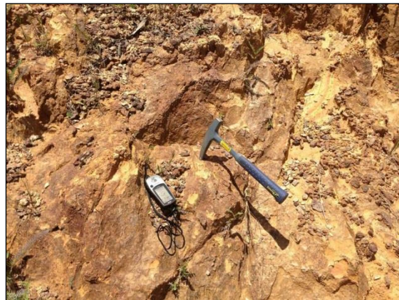
Foto 1.5: Filito Canastra – Perfil bastante alterado, com remanescentes da estrutura bandada.
