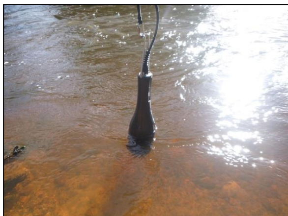
Foto 1.45: Procedimento de coleta de dados de coleta de parâmetros in situ e tempo real com equipamento multiparâmetro.
