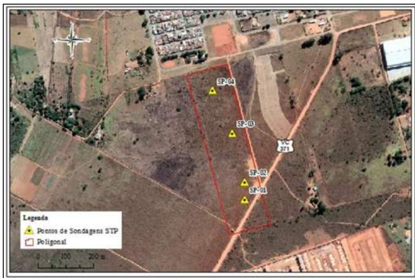
Figura 2: Localização dos pontos de sondagem SPT.
