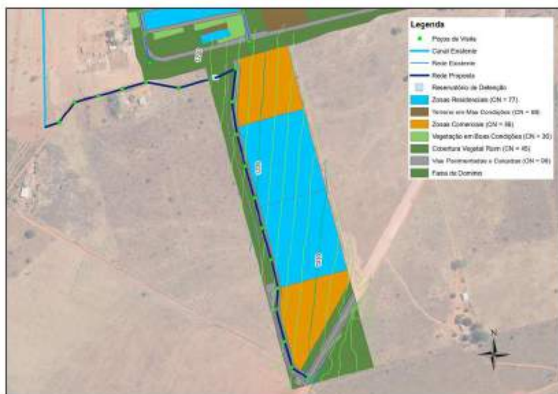
Figura 3: Sistema de Drenagem Proposto. Fonte: Empresa RHUMB.
