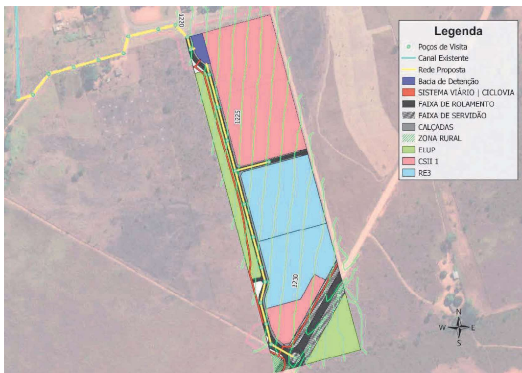
Figura 3: Sistema de Drenagem Proposto. Fonte: Empresa RHUMB.
