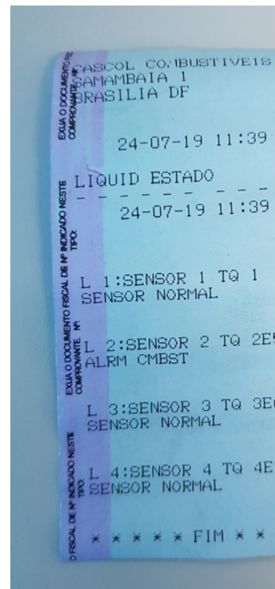
Foto 08 - Relatório emitido, mostrando se o sensor está funcionando. O sensor do tanque 02 apresentou
