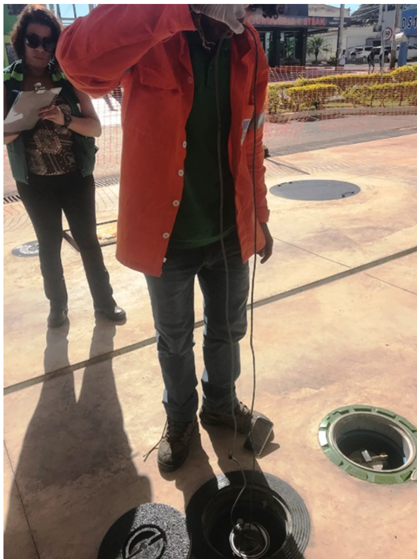
Figura 15 - Verificação no local do Monitoramento do interstício de um dos SASC.
