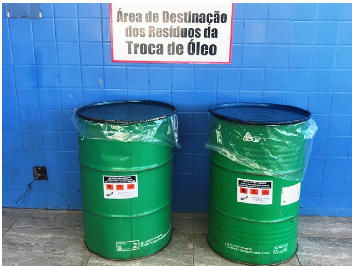
Figura 21 - Tambores utilizados para o acondicionamento de resíduos classe 1.
