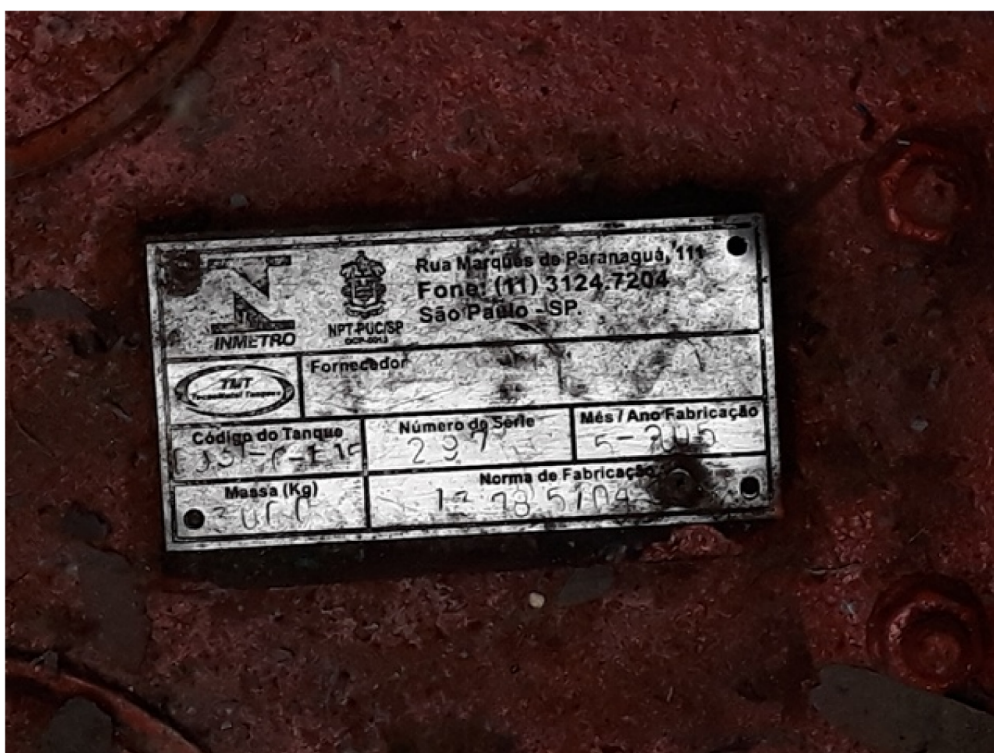
Figura 5: Placa de identificação do tanque com ano de fabricação de 2005.
