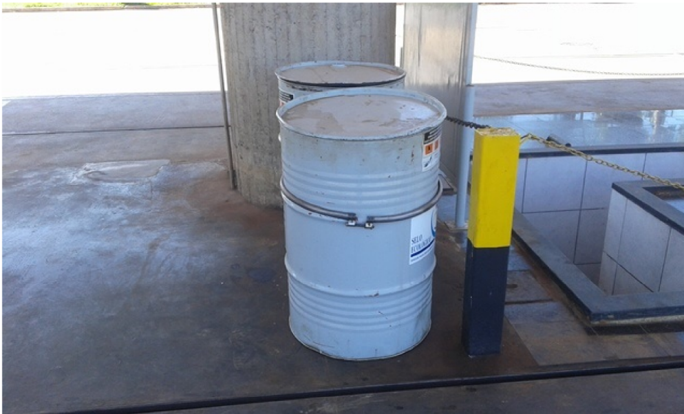
Figura 18: Tambores de resíduos classe I em área coberta e cercada por canaletes.
