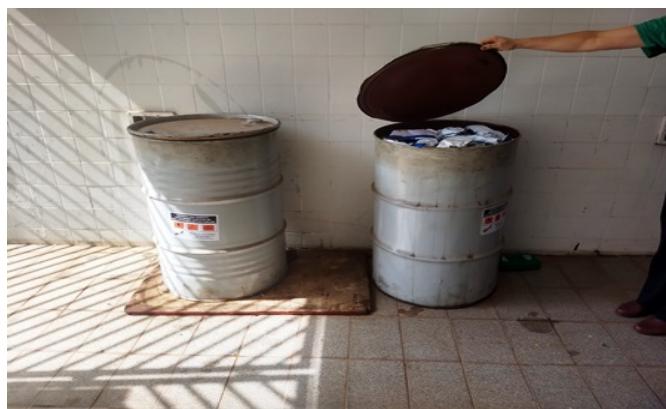
Foto 27 - Tambores metálicos contendo resíduos classe I, em área coberta e contemplada por canaletes.
