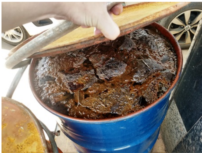
Foto 23 - Resíduos provenientes do SSAO da pista de abastecimento em local coberto e cercado por canaletes.
