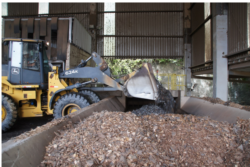
Foto 04 – Detalhe do carregamento da esteira para o abastecimento do forno.
