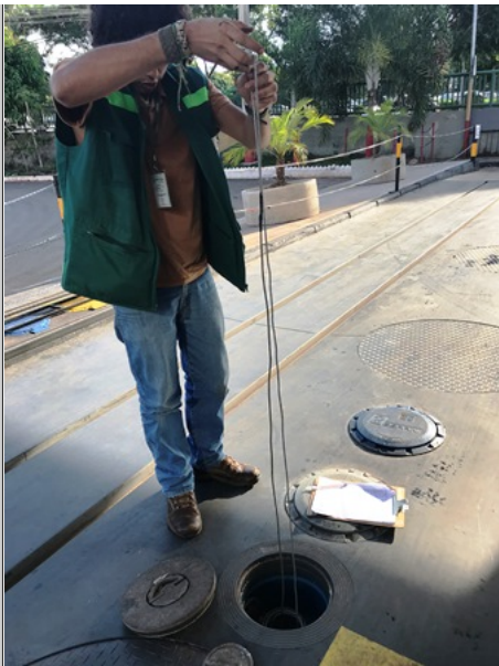
Foto 36 – Detalhe do monitoramento ambiental intersticial de um dos 3 SASC no dia 15/10/2018
