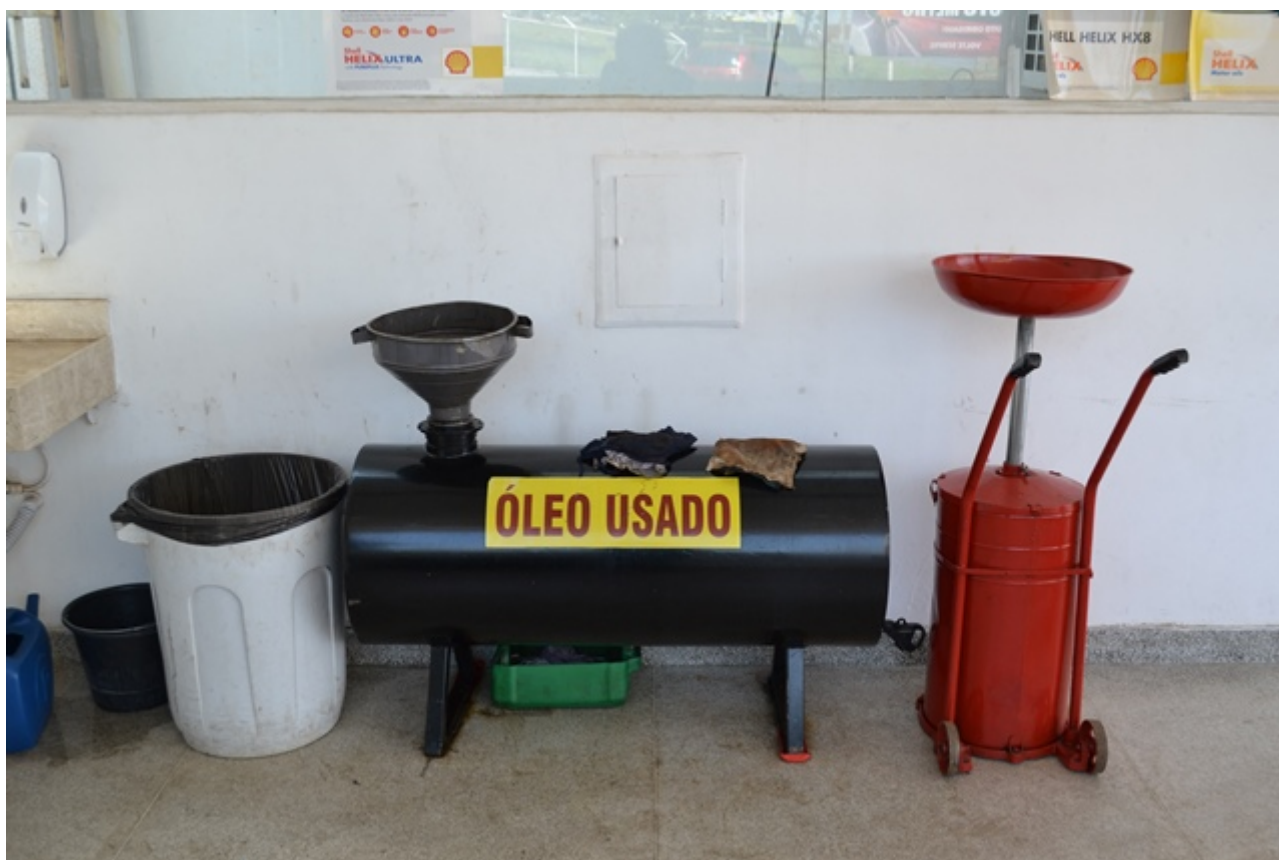
Figura 20 : Tanque aéreo de OLUC.
