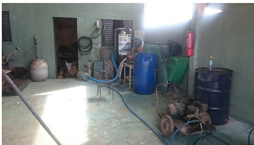
Figura 06: bombona plástica e tonel metálico destinados ao armazenamento de resíduos sólidos classe I. Fonte: vistoria IBRAM, 15/12/2017.
