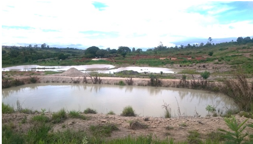
Figura 16: bacias de decantação de argila. Fonte: vistoria IBRAM, 15/12/2017.
