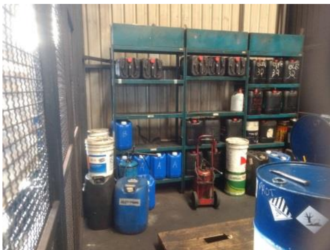
Figura 8 - Área de armazenamento de produtos químicos, isolada mas sem as devidas contenções.
