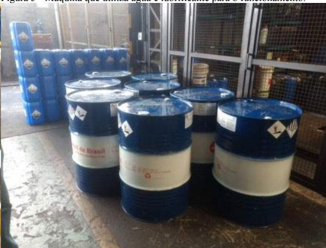
Figura 7 - Embalagens de produtos químicos fora da área de armazenamento.
