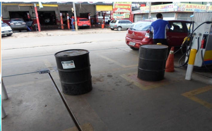
Foto 18: Tambor de óleo e demais resíduos de classe I, fora do local circulado por canaletes.
