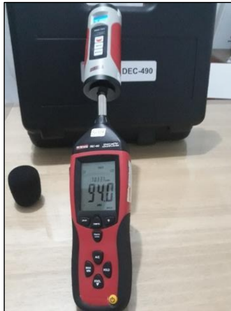
Figura 47: Foto do medidor de nível de pressão sonora utilizado no levantamento
