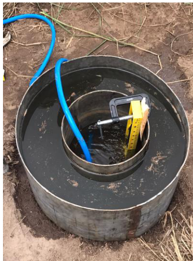
Figura 1 – Demonstração do ensaio de infiltração com infiltrômetro duplo anel
