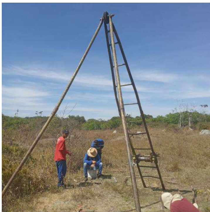
Figura 26. Ensaio SPT realizado em agosto/2023.
