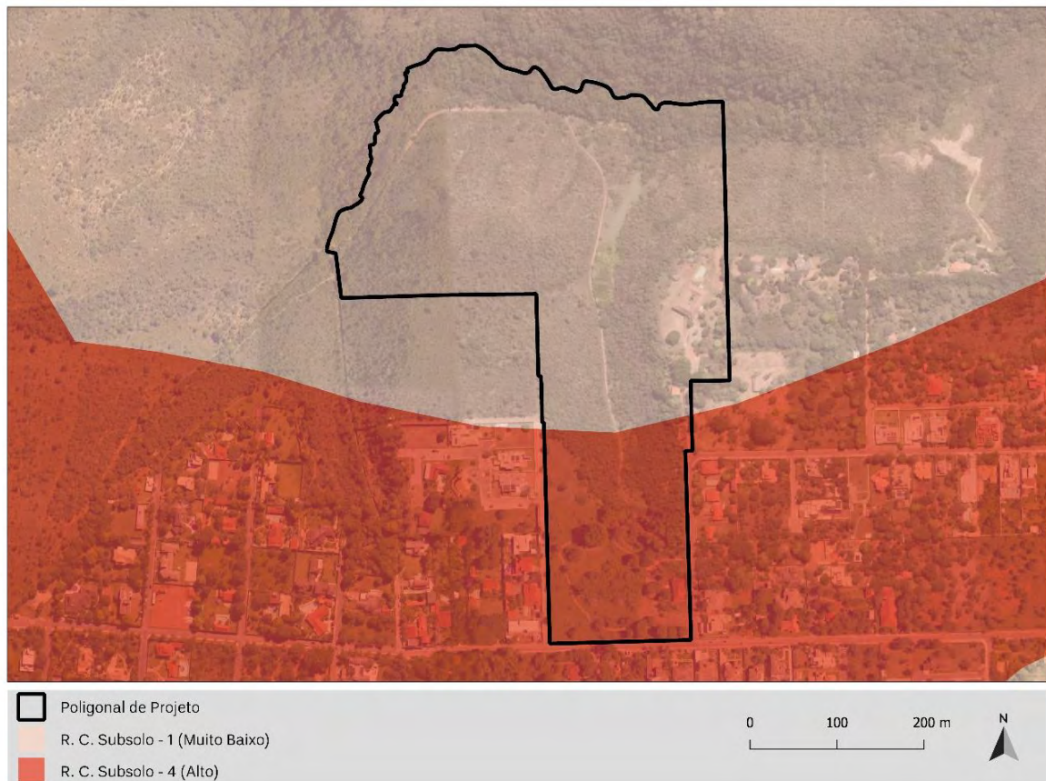
Figura 14: Localização da gleba em relação ao Risco Ecológico de Contaminação do Subsolo do ZEE-DF. Fonte (metadados): https://www.geoportal.seduh.df.gov.br/mapa/# , editado por AGC Projeto e Planejamento.
