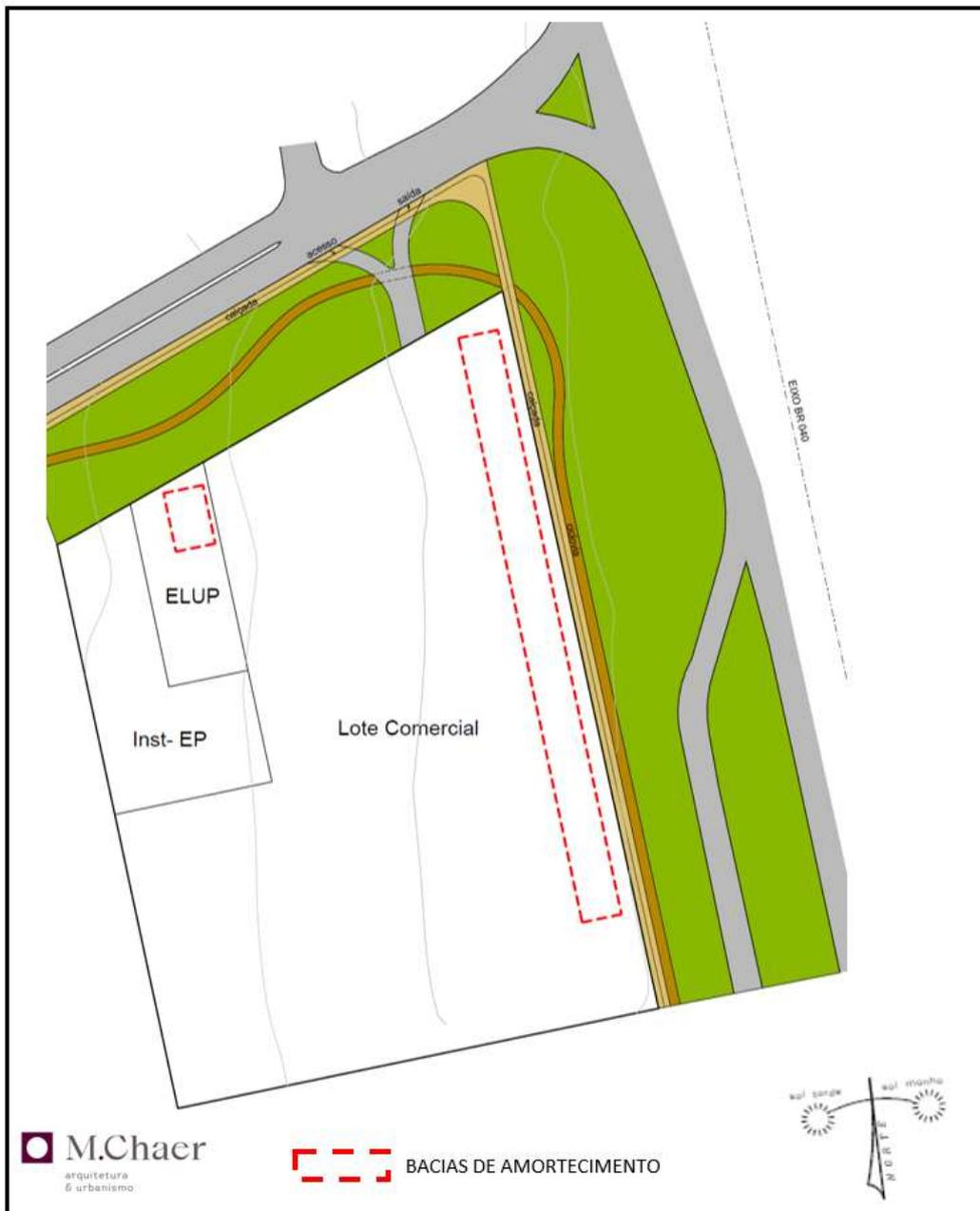
**Figura 03:** Croqui indicativo das bacias de amortecimento para águas pluviais.
