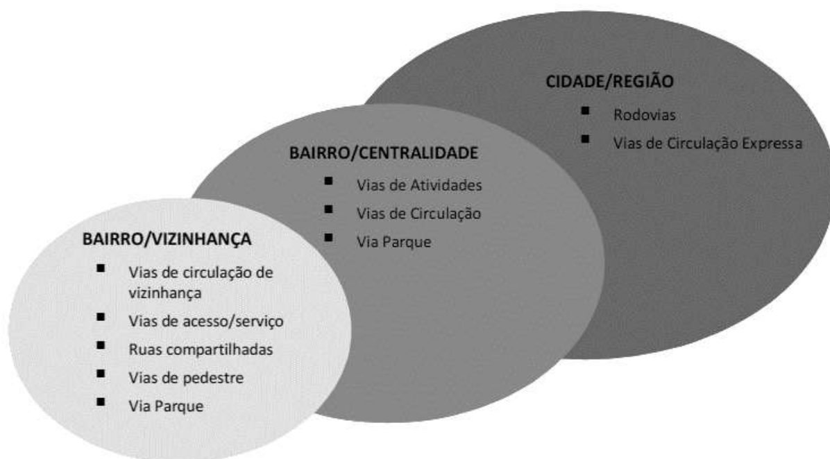
Figura 32. Classificação das vias urbanas de acordo com NT 02/2015 DAUrb-SUAT. Fonte: Nota Técnica NT 02/2015 DAUrb-SUAT.
