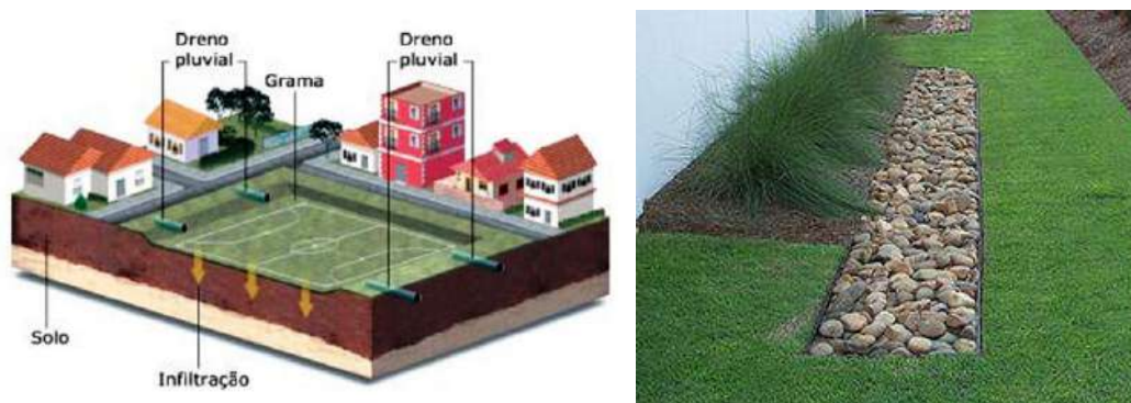
Figura 39. Exemplos de bacia de detenção/retenção e trincheira de infiltração. Fonte: Esquerda: https://goo.gl/m3o1Fz . Direita: https://goo.gl/yvZvsG
