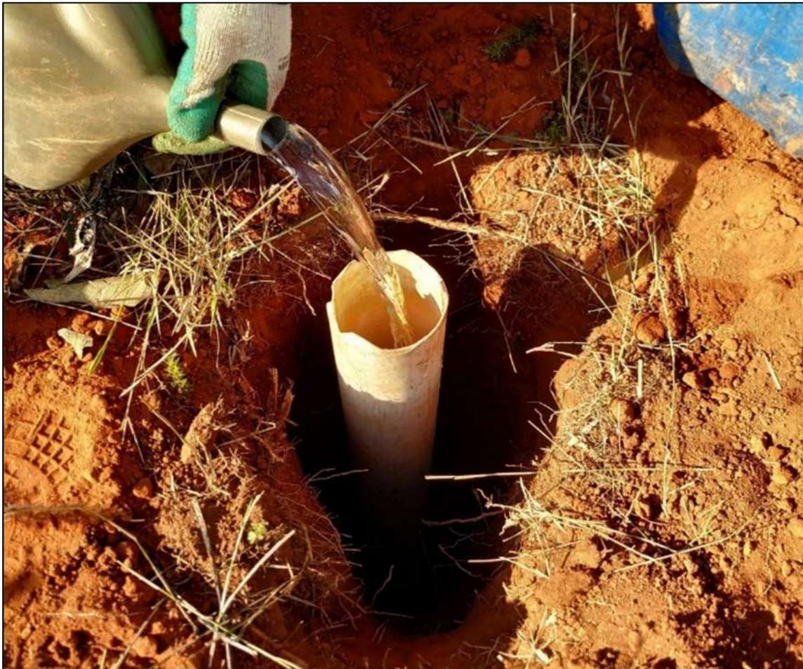
Foto 18: Preenchimento do cano PVC com água para posterior medição da altura do nível d'água.
