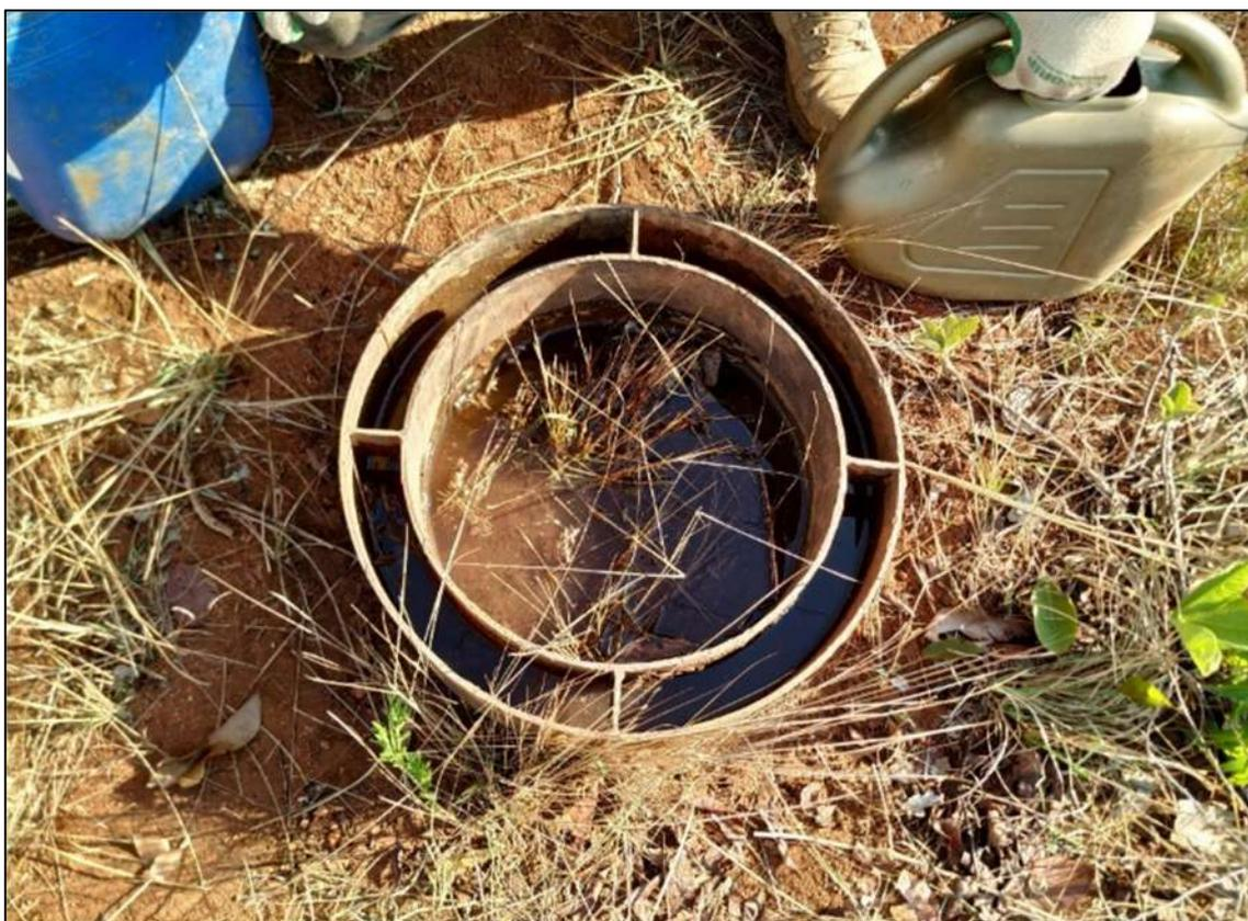
Foto 17: Preenchimento do anel externo para garantir a infiltração vertical da água posteriormente adicionada ao anel interno.
