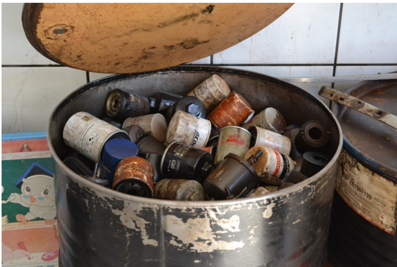
Figura 21: Tambores de armazenamento de resíduos classe I, localizados na área de lubrificação coberta e cercada por canaletes.
