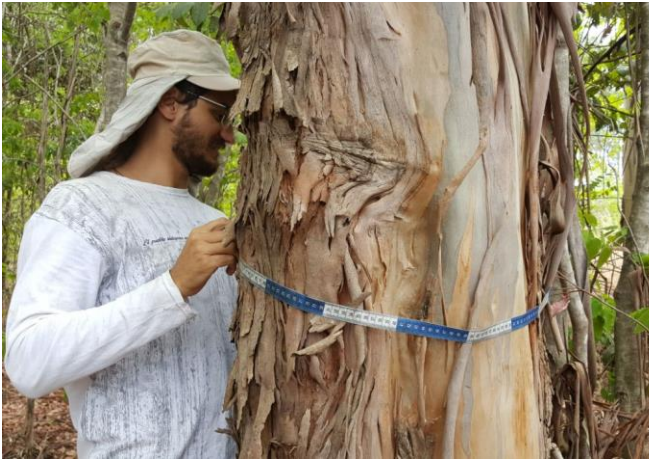
Foto 9 – Medição de circunferência à altura do peito para indivíduo exótico de Eucalipto.
