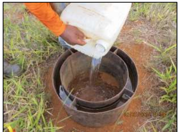
Foto 24: Ensaio de infiltração pelo método dos anéis concêntricos.
