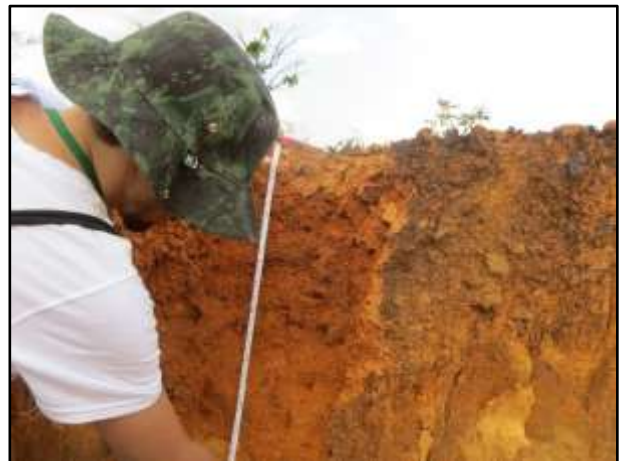
Foto 16: Estudo de solos (medição de horizonte).
