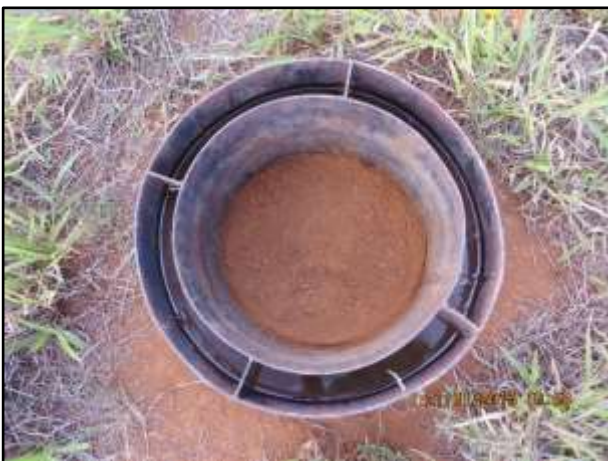
Foto 23: Ensaio de infiltração pelo método dos anéis concêntricos.
